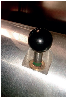
Abb. 6 Kugelkopf mit grüner Markierung.
