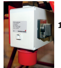
Abb. oben: Hauptschalter und Steckdose mit Phasenwender an der Wacker Putz- und Fräsmaschine 400 V
